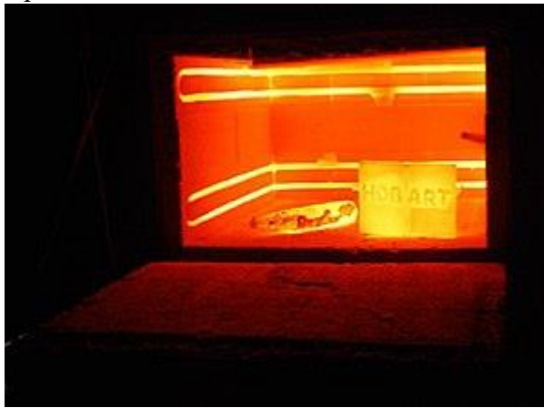
sl 1. Peć za zagrevanje čelika /do 980°/
